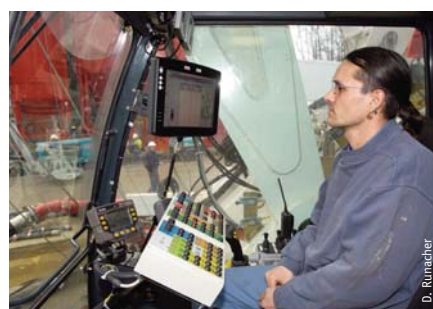
Cabine de pilotage de l'hydrofraise, équipée du système Enpafraise
