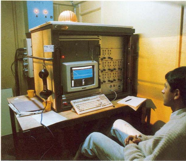
Système EPICEA : enregistrement et pilotage de l'injection
