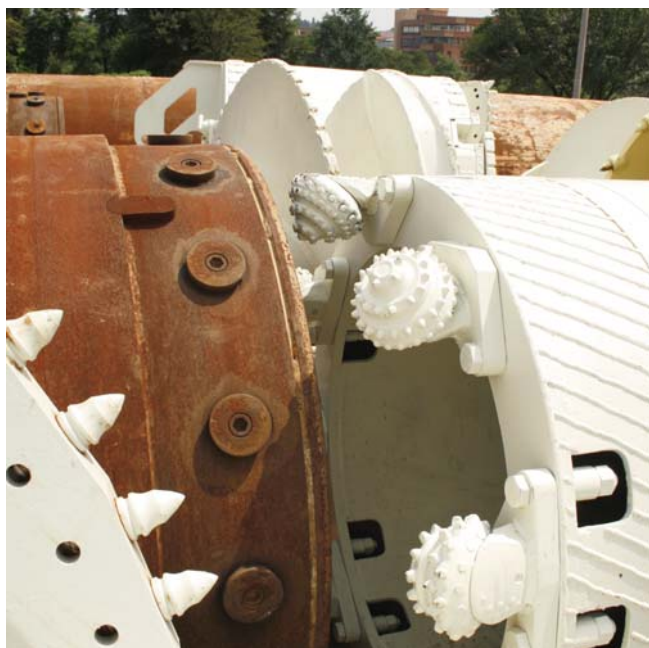
Trépan carottier à molettes utilisé pour découper la roche dure
