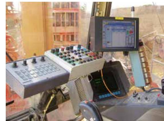
Cabina de mando de Hidrofresa® con ENPAFRAISE
