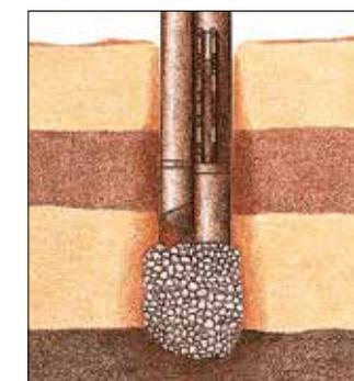
La columna se construye por aporte de grava a través del tubo que bordea lateralmente al vibrador.
