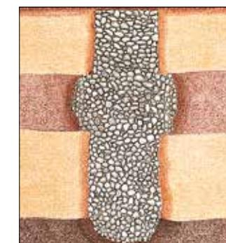
El diámetro de las columnas varía según la resistencia del suelo. Terminación nivelando y compactando la superficie.
