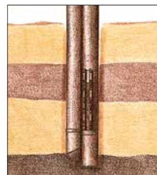
El vibrador desciende hasta la profundidad deseada bajo el efecto de las vibraciones y penetración con aire.
