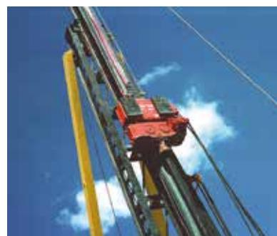
Mástil de perforación del mandril con vibrador en el cabezal
