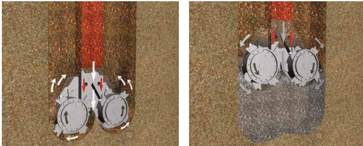
*Le terrain est détruit lors de la perforation. Les produits d'excavation sont déplacés vers le dessus de la tête de coupe. Lors de la remontée, le mouvement de la machine déplace le mélange du dessus vers le dessous de la machine. Un liant est alors injecté et mélangé.*
