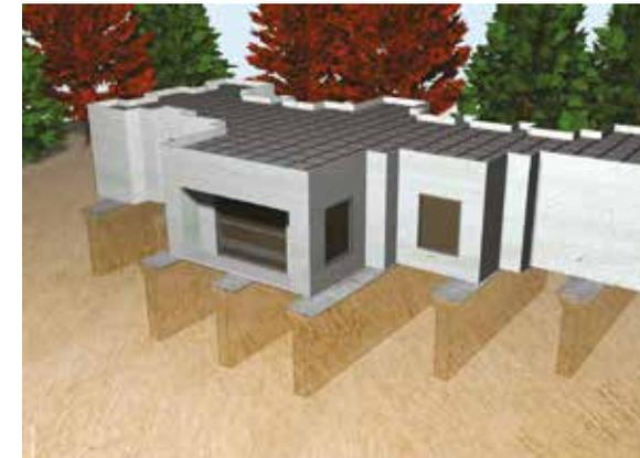
**Réalisation d'écrans d'étanchéité** pour zones polluées ou confinement de réduction des débits de percolation.
