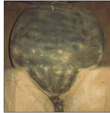
Vue d'une incorporation de mortier dans du sable fin
