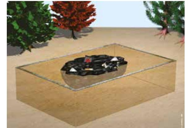
**Réalisation de soutènements provisoires** en association avec la mise en place d'éléments verticaux résistants (profilés métalliques, tubes, poteaux).
