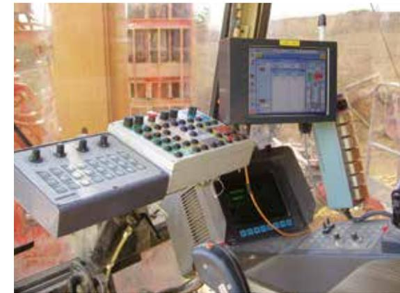
Poste de pilotage d'Hydrofraise® avec ENPAFRAISE
