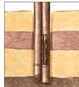
Le vibreur descend jusqu'à la profondeur souhaitée sous l'effet des vibrations et du lançage à l'air.
