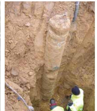
Colonne d'essai excavée
